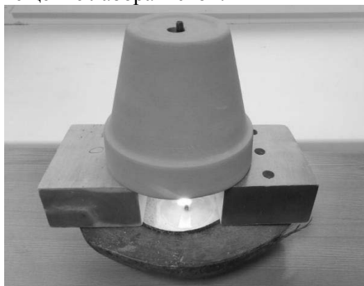
Рис 2. Собранная конструкция обогревателя в действии
