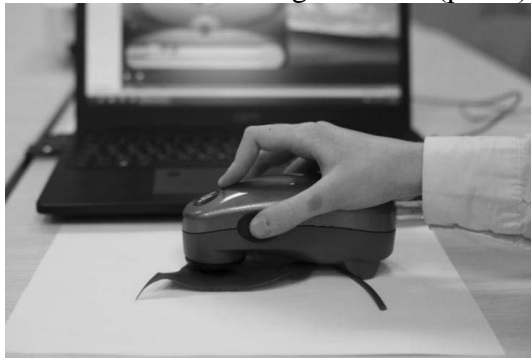
На рис. 1 показано определение спектральных показателей листа липы с помощью цифрового спектрофотометра X-Rite i1Pro 1.
