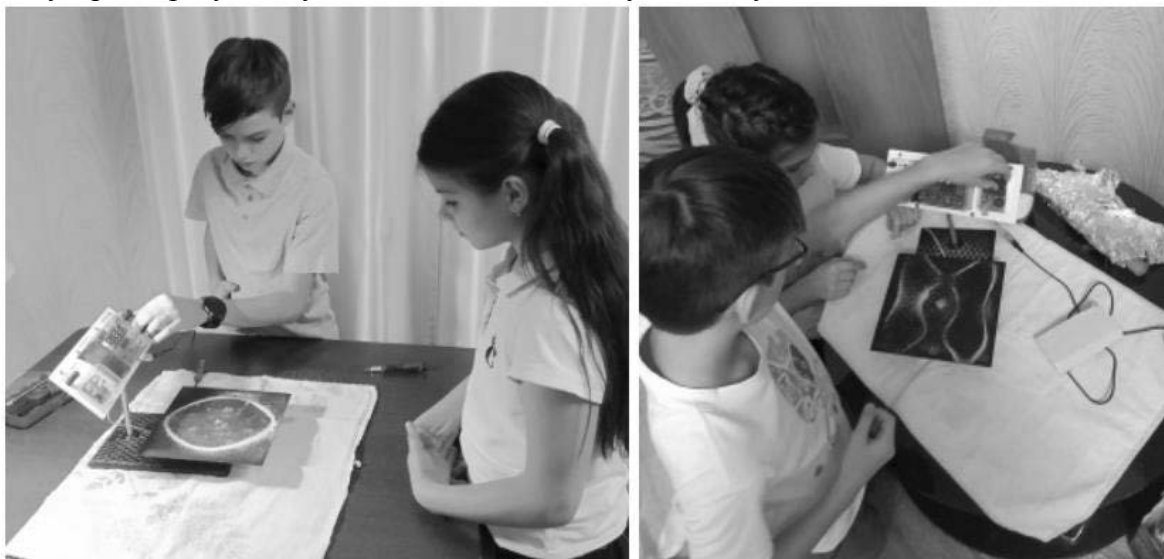
Рис. 1. Формирование фигур Хладни при частоте 200 Гц и 2500 Гц
