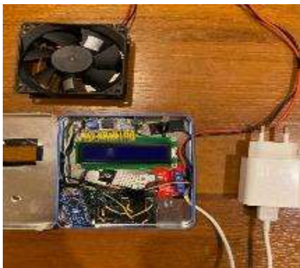
Рис. 5. Подключили кулер к Mosfet транзистору
