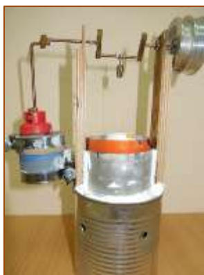
Фото 1. Модель двигателя Стирлинга
